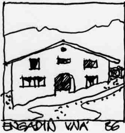
Holzkanppheit, Rauhes Klima und eine Voeliebe für den Steinbau können zum völligen Zurücknehmen der Pfettenkonstruktion, die hier beim Engadinerhaus sehr sparsam auf Mauerwerks-scheiben aufgelagert sind, führen.
