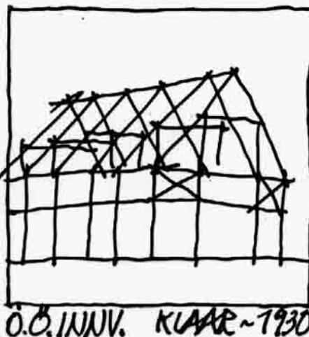
Mit den steigenden Ausmaßen der gesindereichen Betriebe wachsen auch die Baukubaturen, die mit dem ursprünglichen selbstaufgeschlagenen Sperrhaxendach nicht mehr bewältigbar sind. Professionelle Zimmermannsarbeit wird obligat.
