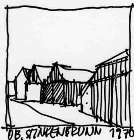
Mit dem Verlust differenzierter Funktionen ist der "Hallenbaukasten" zu kompliziert geworden: Das Bild zeigt eine chronologisch zu verstehende Abfolge: Zuerst verschwinden die Abseiten, dann wird der Unterbau gemauert, dann wird das Giebfeld massiv ausgeführt und zuletzt wird nur noch ein gänzlich unbrennbarer Pultdachschuppen errichtet.
